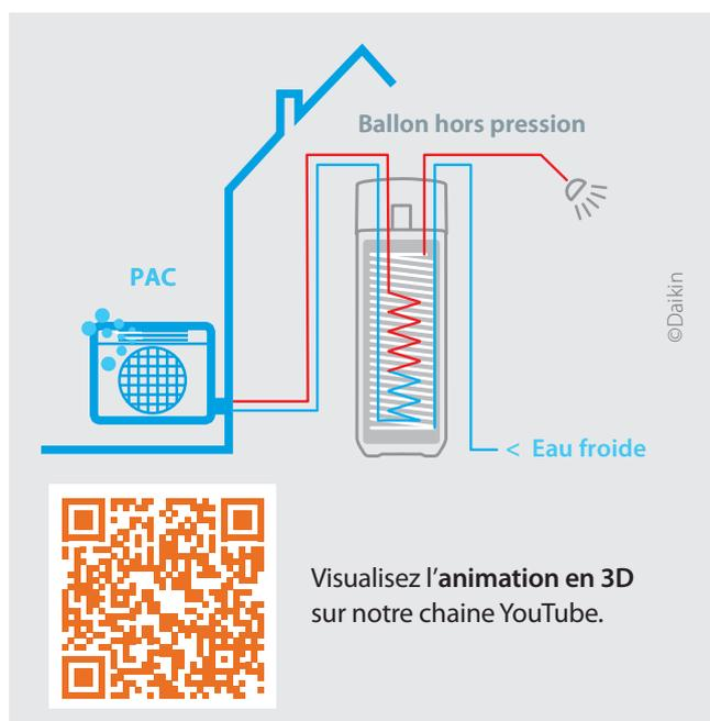
**Les plus :** l'isolation du ballon est assurée par deux enveloppes en polypropylène entre lesquelles est injectée de la mousse de polyuréthane. L'utilisation de cette technologie ne nécessite aucune protection anticorrosion spécifique. En cas de trop-plein, l'eau s'évacue par une sortie de vidange située sur le dessus du ballon. Le polypropylène apporte également une garantie de pérennité et de résistance aux chocs.
